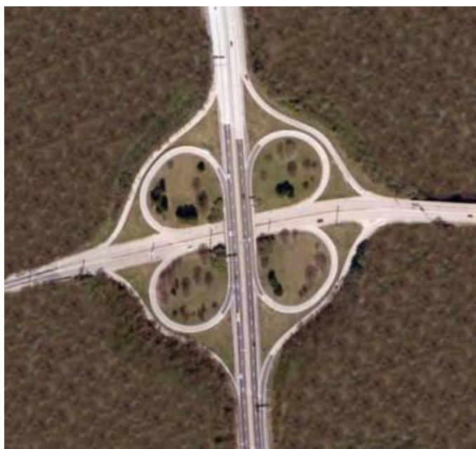
Obrázek 4.7: Dálniční křižovatka složená z úseků klotoid
