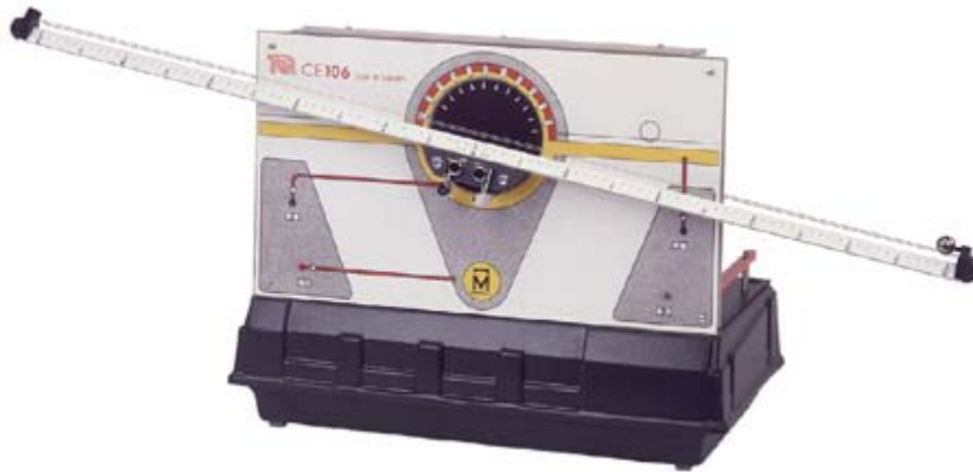
Obrázek 4.1: Laboratorní model CE106 - kulička na tyči.
