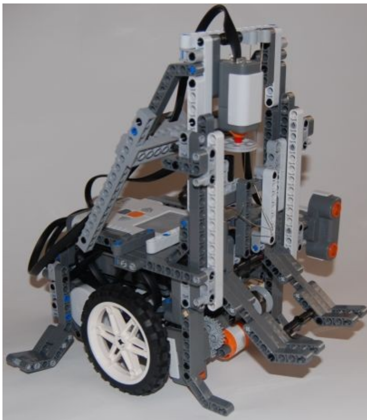
Obr. 4.2: Konstrukční řešení pro úlohu SUMO: vysokozdvizný vozík
