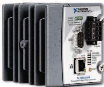
Obrázek 5.1: Fotografie řídícího systému NI cRio 9004, převzato z [17]
