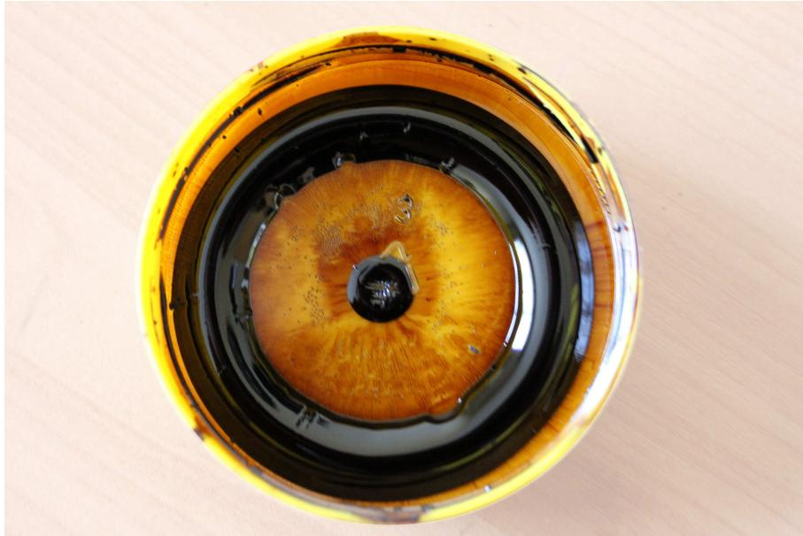
Obrázek 4.17: Magnetické pole generované permanentním magnetem
