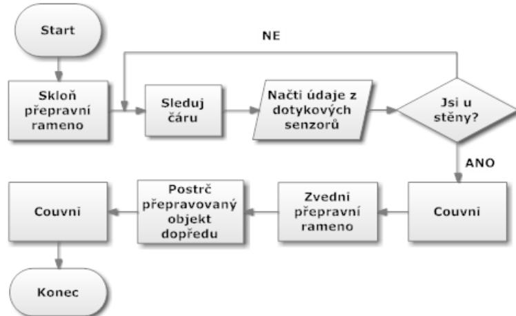
Obrázek 3.13: Vývojový diagram pro ”Odvez objekt do skladovacího prostoru”
