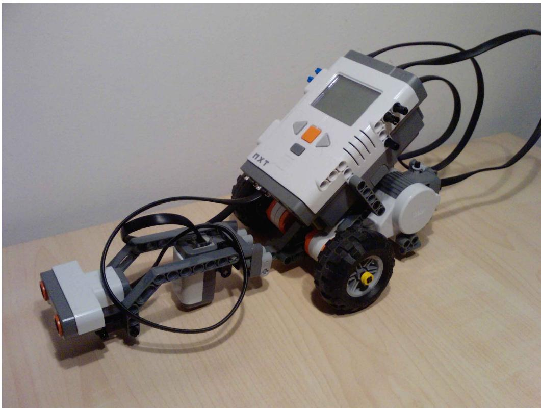
Obrázek 3.2: Konstrukce robota pro Sledování čáry
