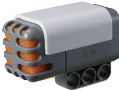
Obrázek 1.5: Zvukový senzor
