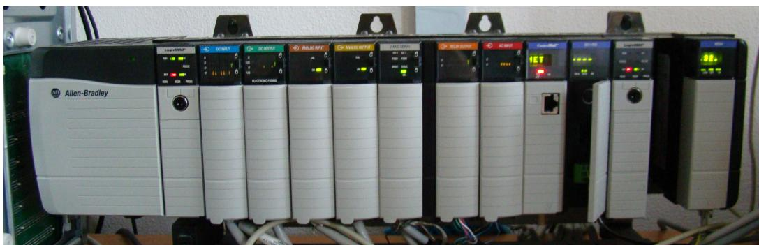
Obrázek 4.1: Automat ControlLogix
