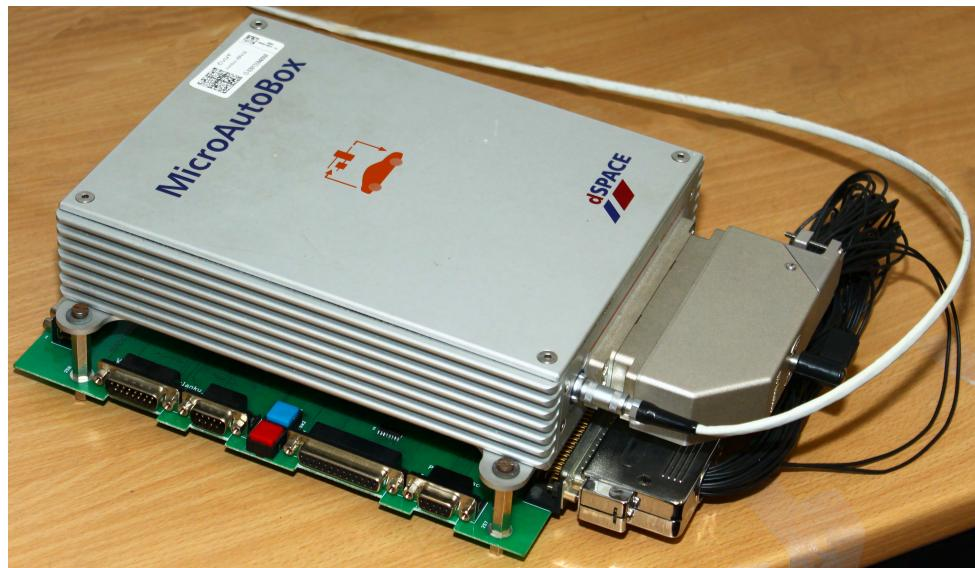
Obrázek 2.4: MicroAutoBox s propojovacím a přizpůsobovacím modulem
