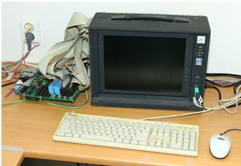
Obrázek 2.2: Průmyslový počítač s deskou dSpace DS1103 a propojovací a přizpůsobovací modul
