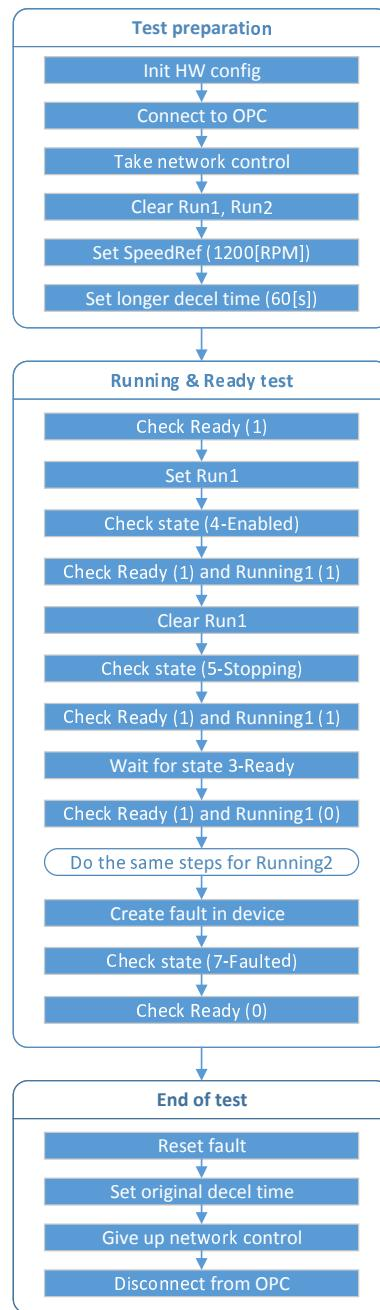
Obrázek C.10: Vývojový diagram testu attributů Running1, Running2 a Ready
