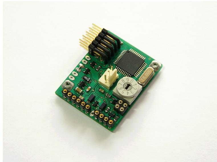
**Obrázek 3.1:** Osazená deska elektronického časovače.
