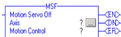
Obr. 28 Instrukce MSF v žebříčkovém diagramu
