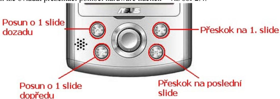
Obr 2.4: Rozvržení ovládání na HW tlačítka
