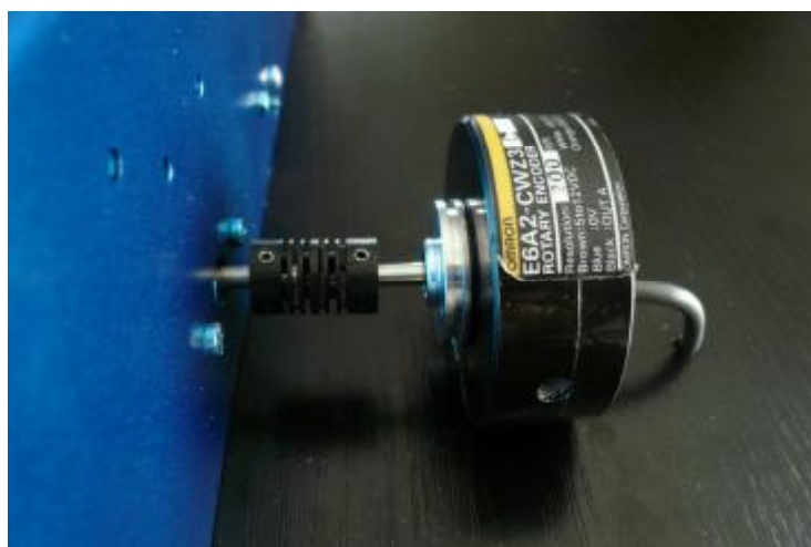
Obrázek 6 – uchycení inkrementálního čidla na přípravku
