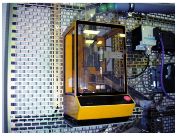
Obrázek 2.15: Laboratorní váha Sartorius 1612MP8
