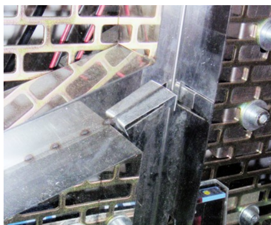
Obrázek 2.6: Zarážka způsobující vychýlení míčku z jeho přirozené dráhy
