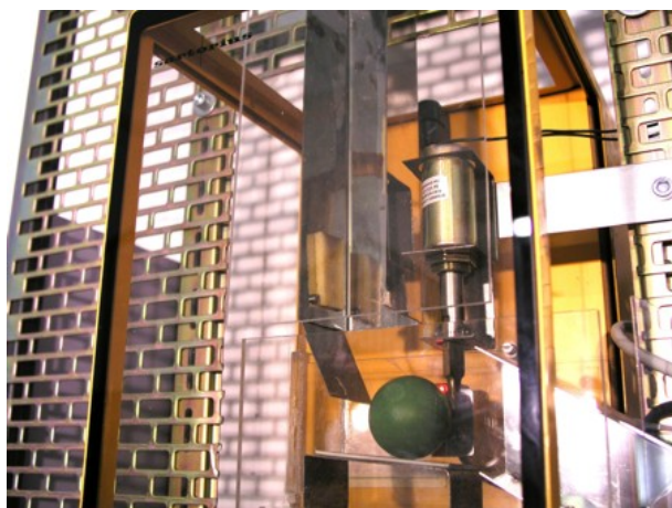
Obrázek 2.5: Mechanická závora u váhy
