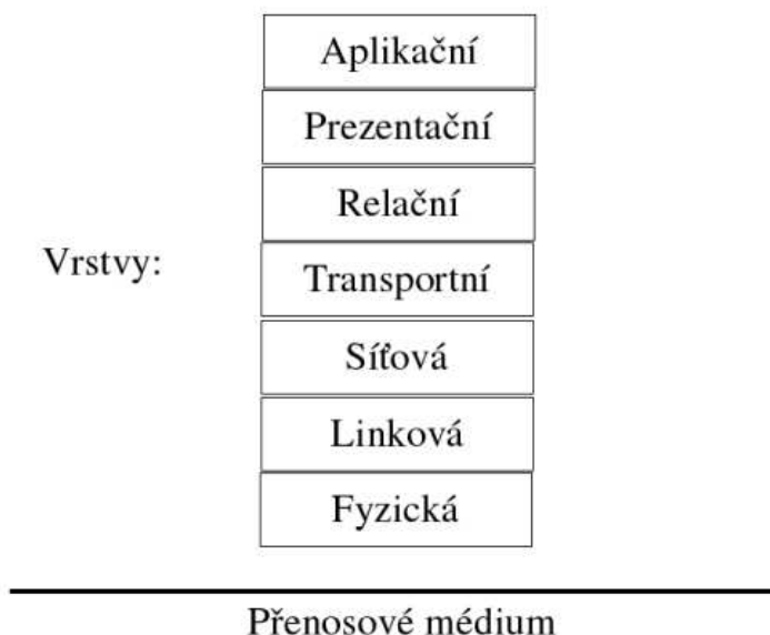
Obrázek 2.1: ISO/OSI model síťových vrstev
