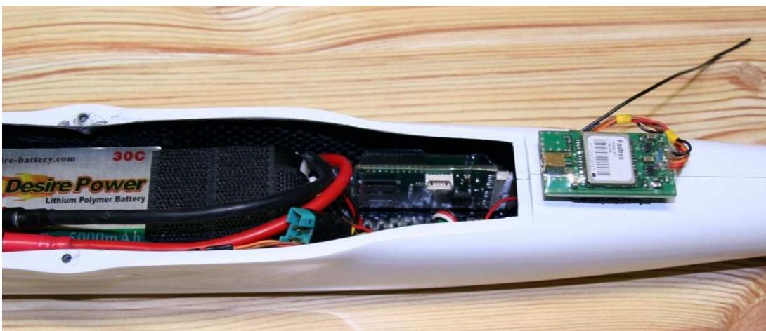
Obr. 7.2: Umístění vysílací stanice v trupu modelu
