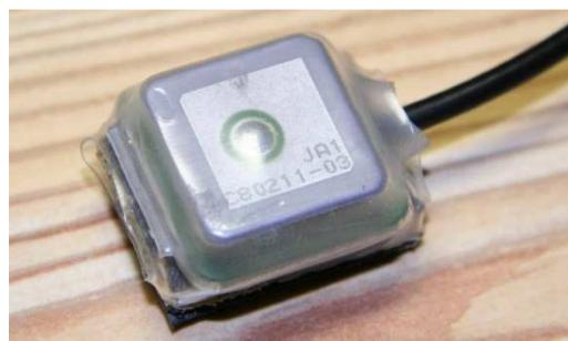
Obr. 3.14: GPS anténa 2J400U
