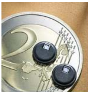
Obrázek 3.1.7.4. Skutečná velikost tlakových senzorů SCP1000
