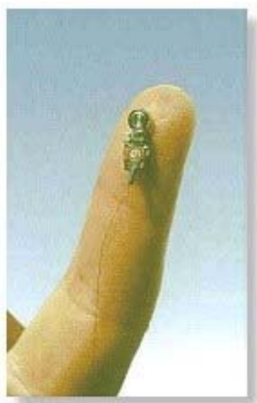
Obrázek P.4.: Nejmenší jednostupňový vysílač o rozměrech 12x5x2,5mm a hmotnosti 450mg.
