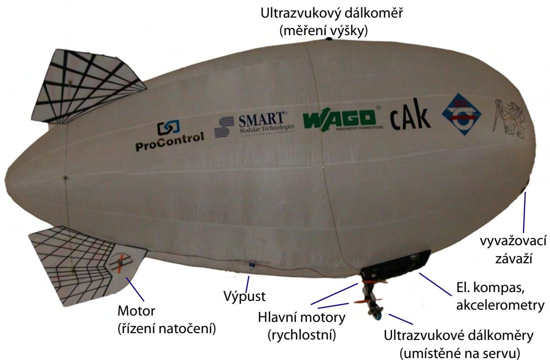
Obrázek 2.1: Model, umístění akčních členů a senzorů
