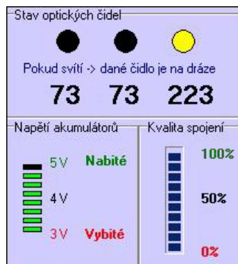
Obrázek 4.14: Informace o napětí akumulátorů, stavu optických čidel a kvalitě spojení
