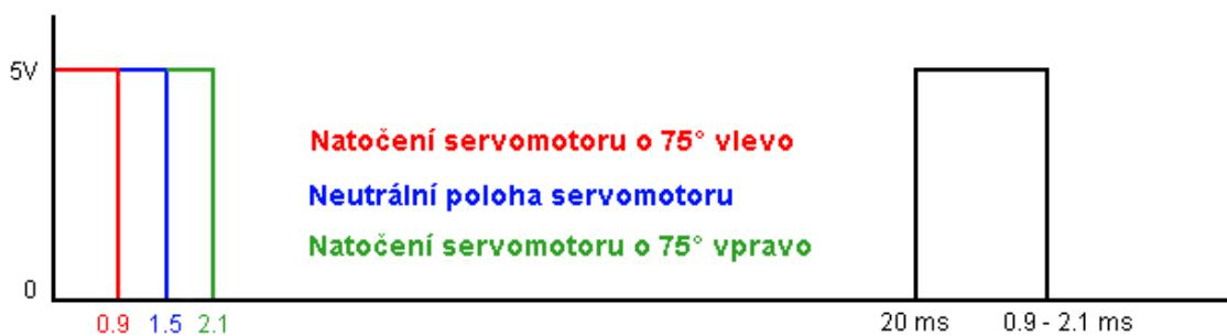
Obrázek 3.9: Časové průběhy PWM pro servomotor
