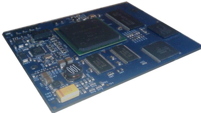
Embedded modul Shark ([2]) je založen na popsaném procesoru MPC5200B. Modul je postaven na základě podobného modulu německé firmy TQ Components ([3]) s názvem TQM5200 a je tak s ním pinově kompatibilní, další vlastnosti už jsou však upraveny pro plánované použití.
