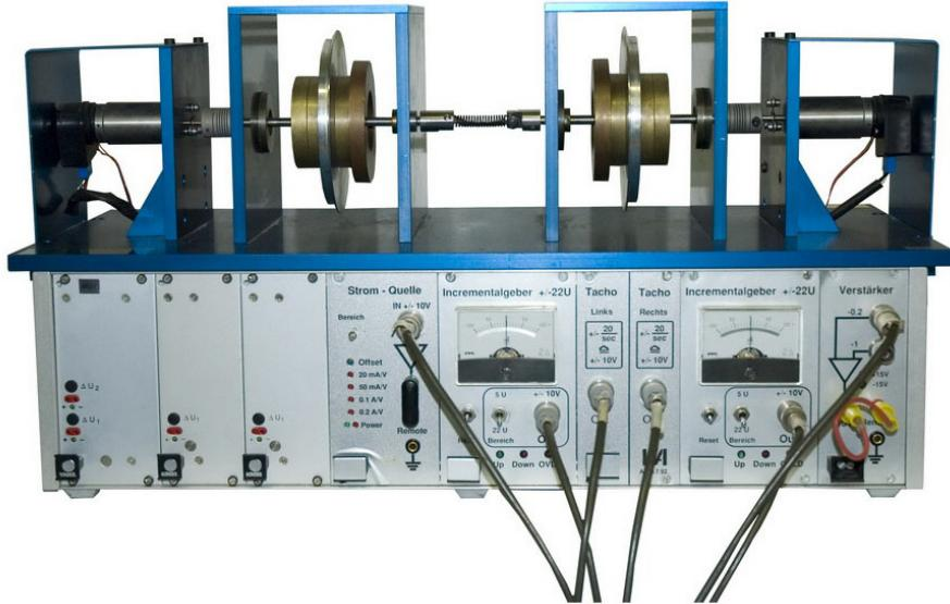
Obrázek 1.1: Laboratorní model se spojenými servomotory ETH (SE)
