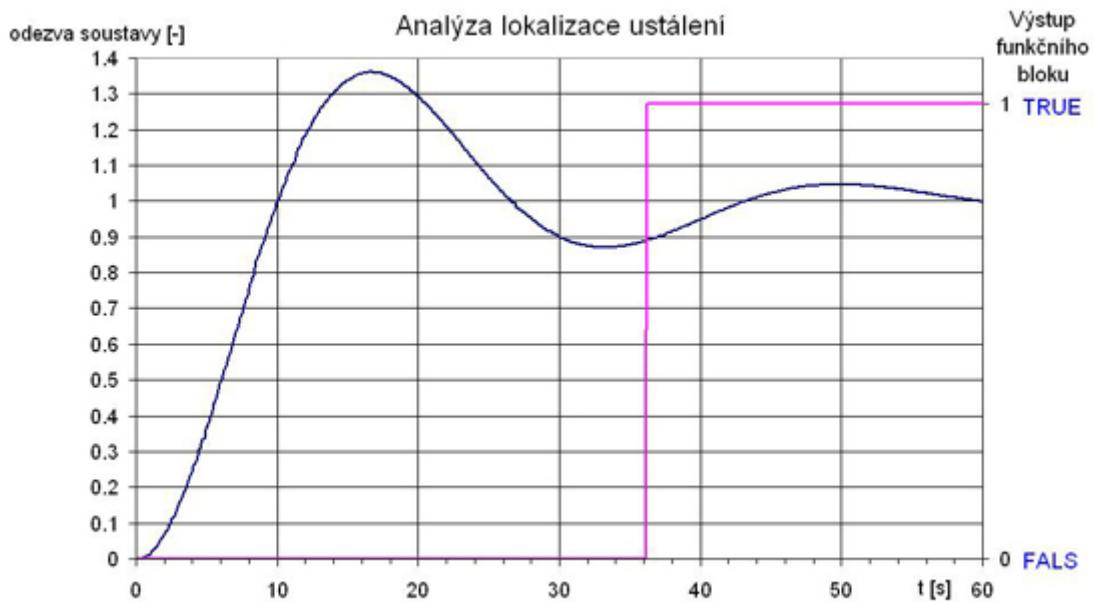
Obrázek 2.15: Příklad detekce ustálení
