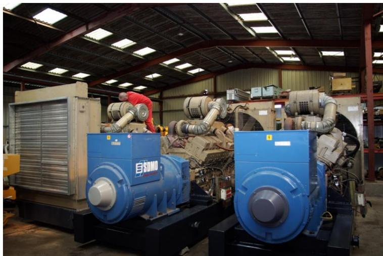
Obrázek 1.4: příklad motorgenerátorového zdroje 2000 kVA
