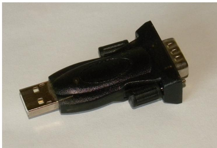
Obrázek 3.3 Převodník USB/RS-232
