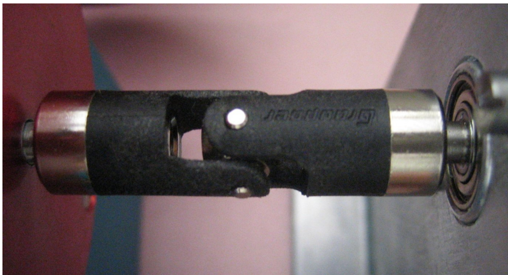
Obr 3.2 Pružná spojka pro spojení enkodéru s hřídelí potenciometru
