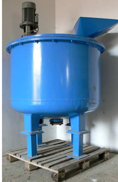
Obr 4.7 Reakční nádoba pro druhou fázi (cca 1000l)
