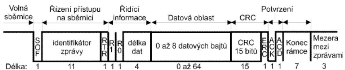
Obrázek 3.3: Datový rámec CAN 2.0A.
