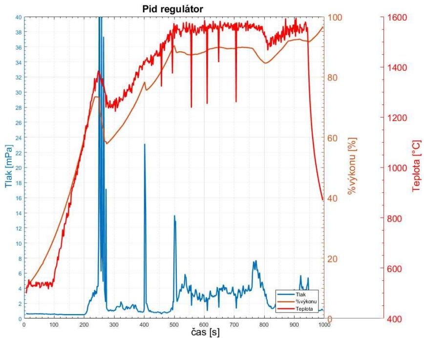
**Obrázek 5.2:** PID regulátor, který několikrát přesáhne povolenou hodnotu 6 mPa
