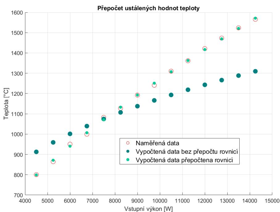
**Obrázek 4.7:** Rozdíl po přepočítání pomocí funkce fit
