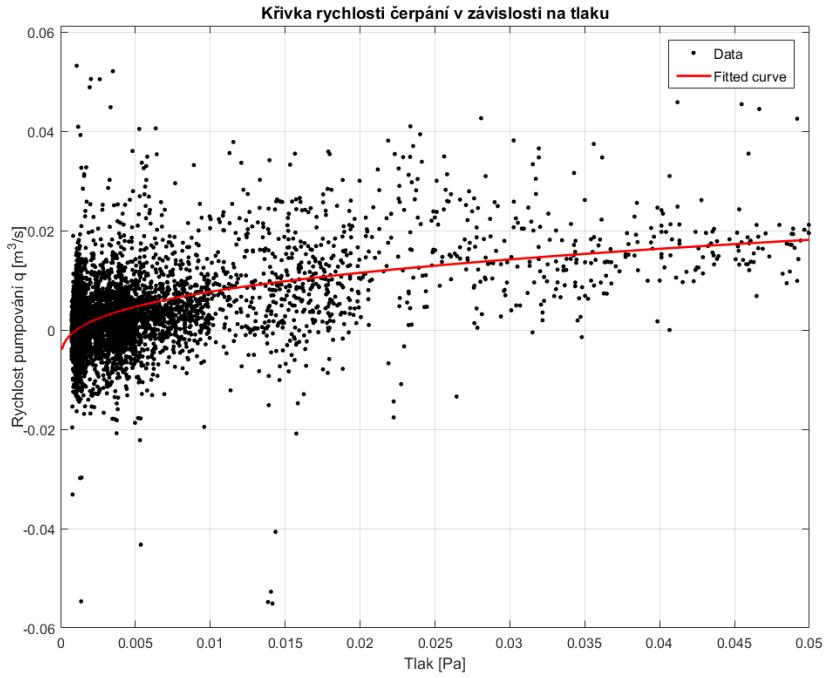
**Obrázek 4.3:** Vypočtená hodnota  $q$  v závislosti na tlaku.
