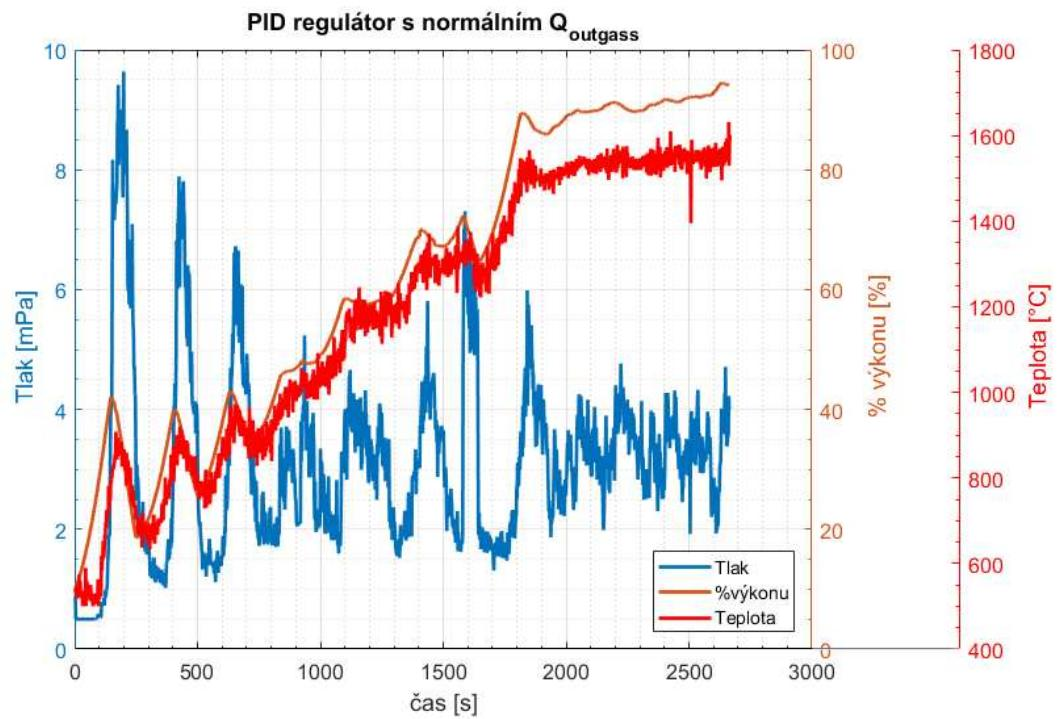
**Obrázek 5.4:** Průběh systému, kde  $Q_{\text{outgass}}$  bylo zmenšeno uložením ve vakuové komoře
