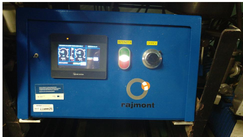
Obrázek 3.3: Přední panel generátoru
