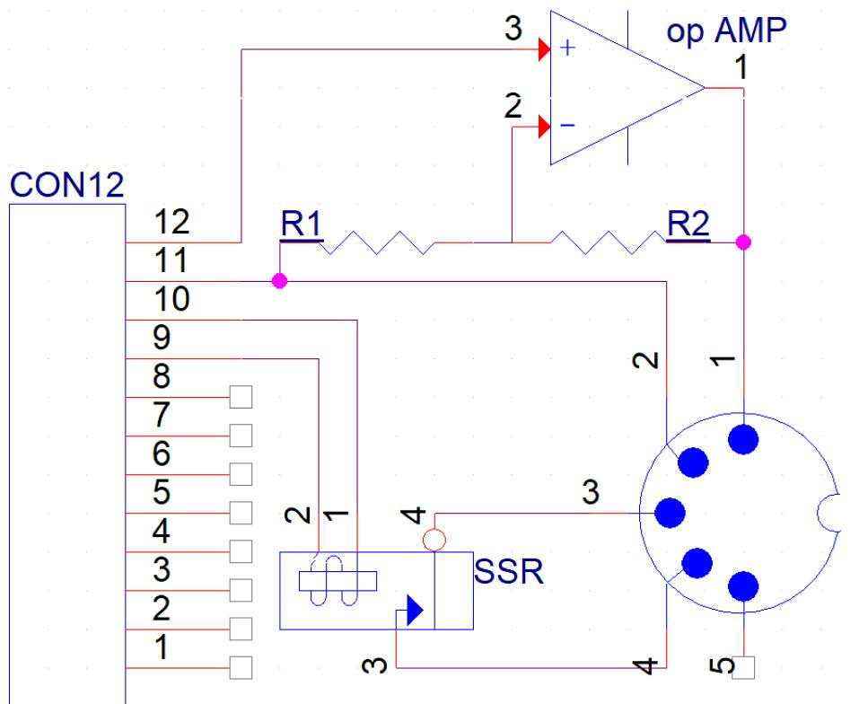
Obrázek 3.9: Vytvořený obvod uvnitř zesilovací krabice
