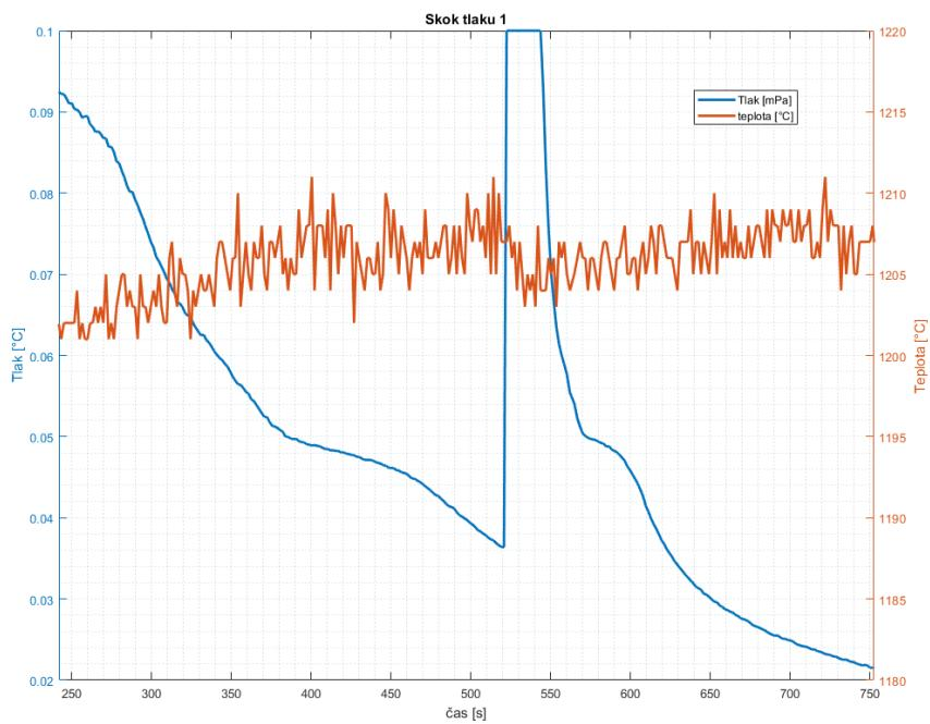
**Obrázek 4.1:** Odezva teploty na extrémní skok tlaku
