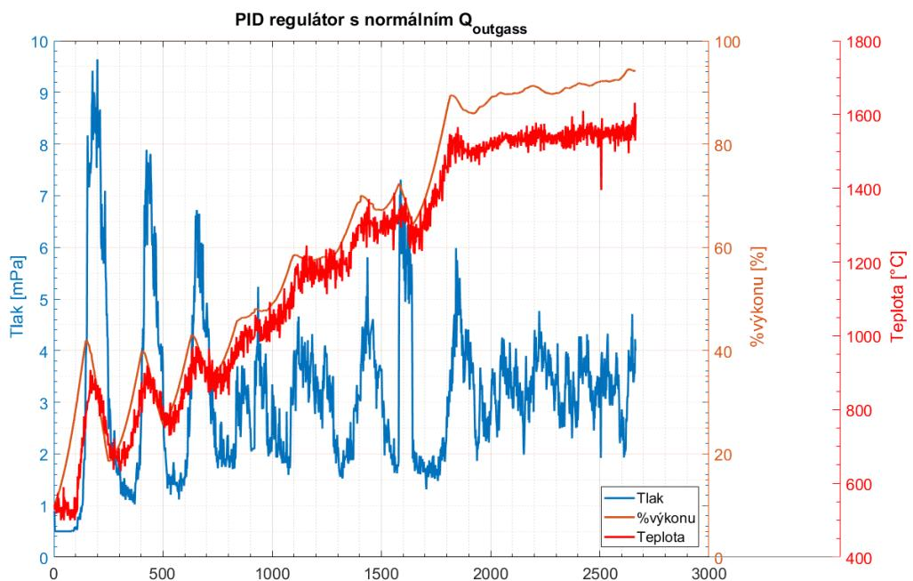
**Obrázek 5.3:** Průběh systému, kde  $Q_{outgass}$  nebylo zmenšeno
