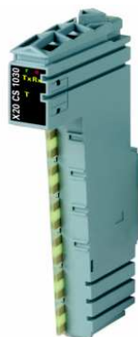
Obrázek 4-13 Modul pro rozšíření CPU pro komunikaci po sběrnici RS-485/232
