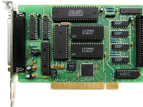
*Obr. č. 11 - multifunkční vstupně výstupní PCI karta MF614 fy. HUMUSOFT s.r.o*
