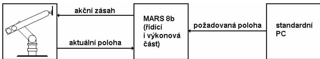
Obr. č. 13 – blokové schéma nového návrhu řízení „PC – MARS 8b“ včetně obecných signálů
