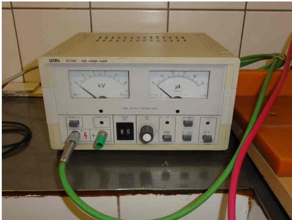
Obrázek 3.3: Laboratrní vysokonapěťový zdroj
