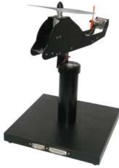
Obrázek 4.2: Laboratorní model CE 150 [26]
