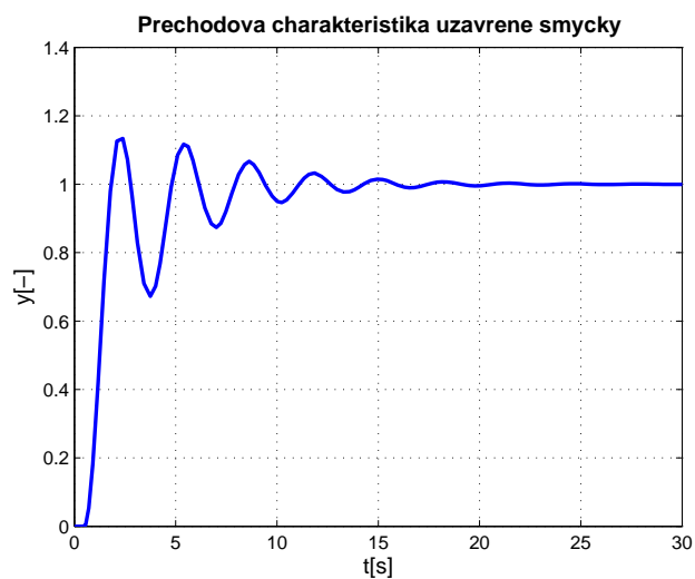
Obrázek 5.10: Přechodová charakteristika uzavřené smyčky s přenosem
