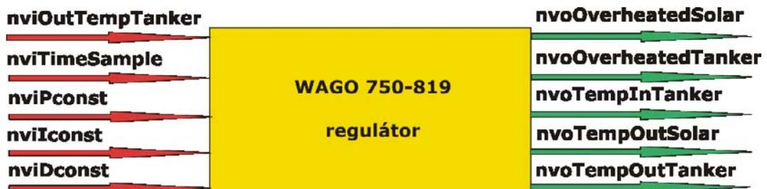
Obrázek 37: Vstupní a výstupní proměnné Wago regulátoru
