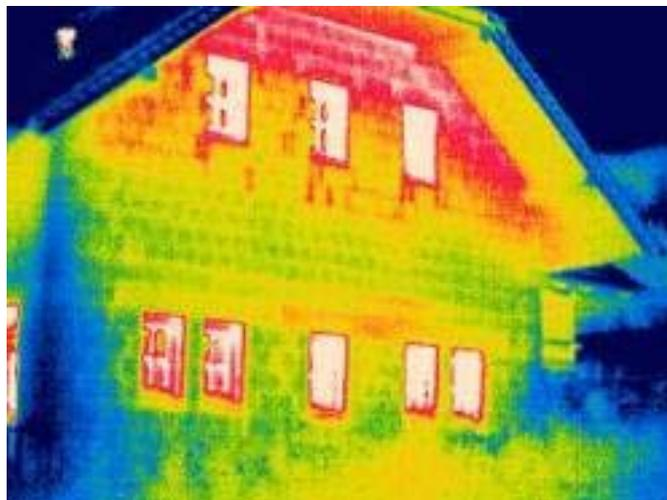
Obrázek 32: Prostup tepla z budovy rodinného domu a demonstrace tepelných mostů
