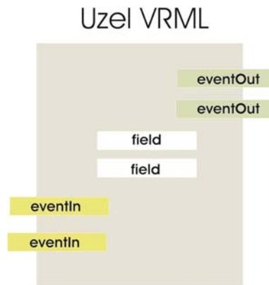
Obrázek 16: Parametry uzlu VRML
