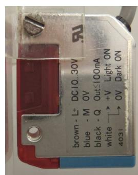
Obrázek 2.6: Optický senzor polohy
