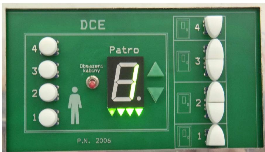
Obrázek 2.4: Vstup / výstupní panel výtahu
