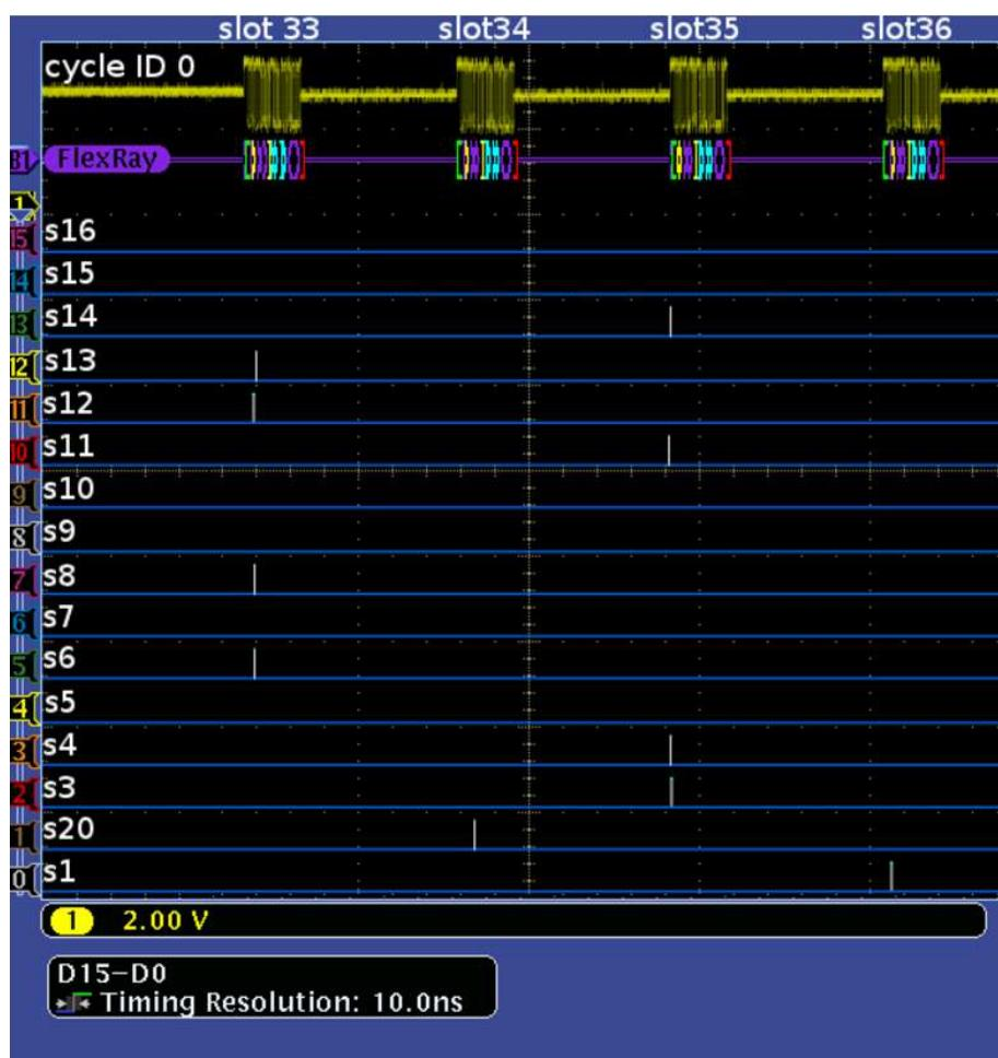
Obrázek 21 - Komunikace na sběrnici při praktickém testu zobrazena na osciloskopu [11]
