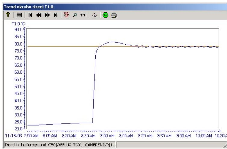
Obrázek 6.4: Průběh teploty v hlavě kolony T1.0
