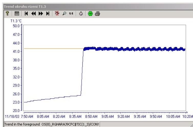
Obrázek 6.2: Průběh teploty v chladiči T1.3
